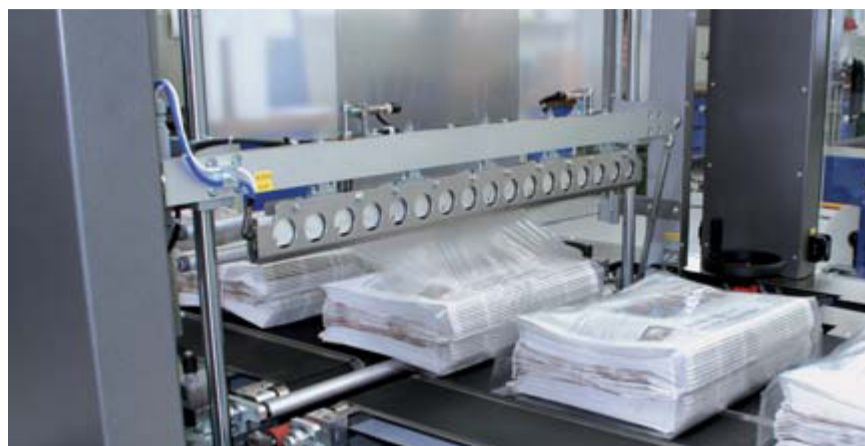
Super Wrap 500 beim Folienbänderolieren von Tageszeitungstapeln ohne Umreifung.
