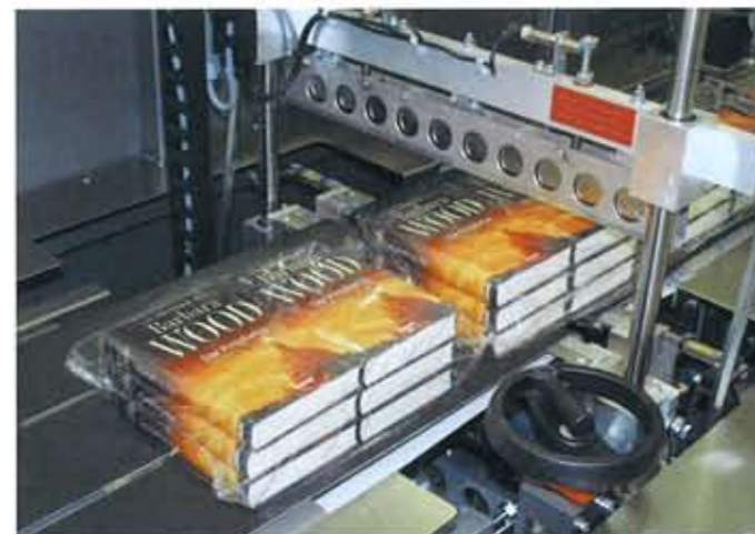
Das mitlaufende Querschweißsystem der Universa 500 Servo minimiert das Verrutschen von gestapelten Produkten.
