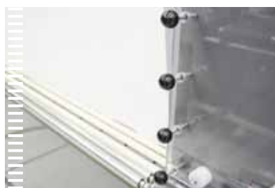
Регулируемые скользящие заслонки дают возможность точно контролировать поток горячего воздуха.
