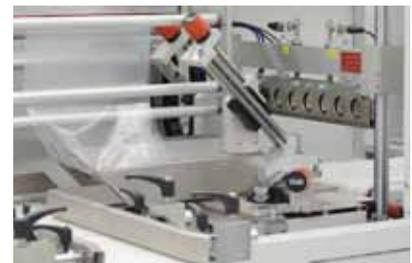
Der Querschweißstempel misst lediglich 350 mm. Einfach verstellbare Formschulter in horizontaler und vertikaler Richtung. Die Produktzuführung erfolgt rechtwinklig zur Durchlaufrichtung.
