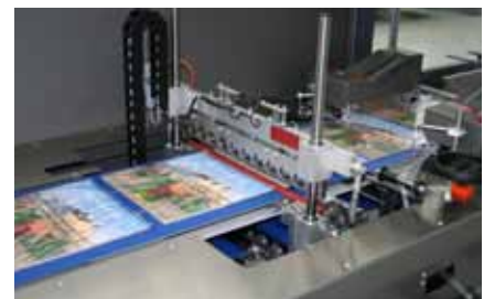
Servo Packer 500. Der schnelle Hybrid vereint Vorzüge einer universellen Seitenschweißmaschine und einer Folienverpackungsanlage, die extrem enges Verpacken ermöglicht.
