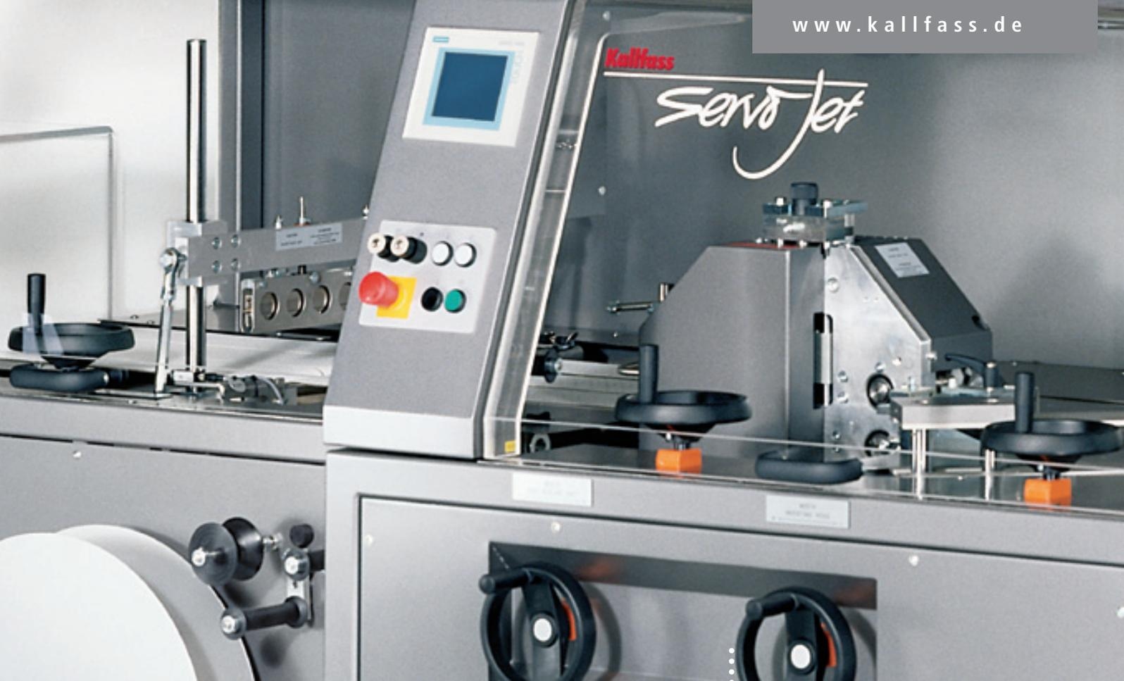
Vollautomatische, kontinuierliche Seitenschweißmaschine
