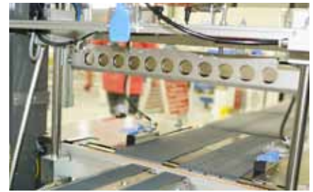
Das Messgitter erfasst die Produktabmessungen für eine jeweils maßgeschneiderte Verpackung
