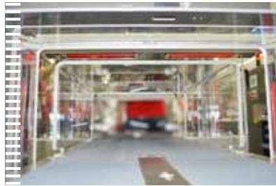
Das Messgitter erfasst die Produktabmessungen für eine jeweils maßgeschneiderte Verpackung
