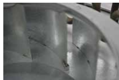
Турбинная система обдува заботится о равномерном распределении воздуха вокруг продукта.
