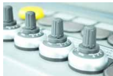
Четыре отдельно регулируемые системы обдува отвечают за равномерную подачу горячего воздуха
