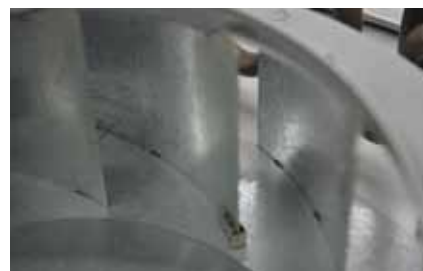
Турбинная система обдува заботится о равномерном распределении воздуха вокруг продукта
