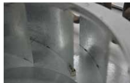
Le système de chauffe par turbines assure une transmission régulière de la chaleur sur le produit.
