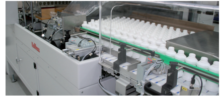
Luftdicht und kompakt in Folie verschweißt gehen Kunststoffflaschen Cleanpacks zu den Abnehmern aus der Pharma- und Medizinbranche. (Foto: Kallfass)
