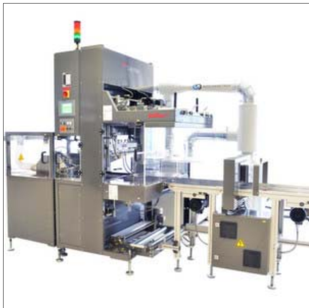
Als Weltneuheit auf der Interpack vorgestellt: die branchenübergreifend einsetzbare Folienverpackungsmaschine Logi Wrap 3D. (Bild: Kallfass)
