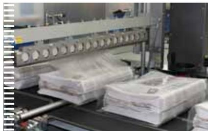
Super Wrap 500: Speziell zum Banderolieren in PE-Folie
