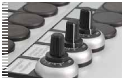
Das Ringdüsen-Heizsystem mit genau einstellbarer Luftmengenregulierung sorgt für eine gleichmäßige Wärmeübertragung in die Folie.
